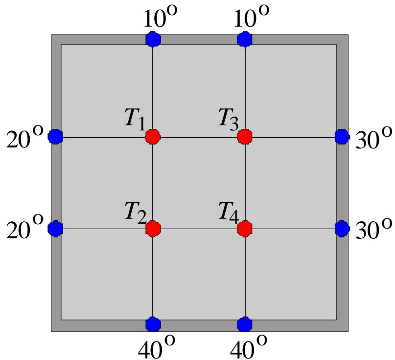
$$\begin{bmatrix} 4 & -1 & -1 & 0 \\ -1 & 4 & 0 & -1 \\ -1 & 0 & 4 & -1 \\ 0 & -1 & -1 & 4 \end{bmatrix} \begin{bmatrix} T_1 \\ T_2 \\ T_3 \\ T_4 \end{bmatrix} = \begin{bmatrix} 30 \\ 60 \\ 40 \\ 70 \end{bmatrix}$$
